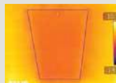
VELTA «Престиж», утепление 70 см - нет потерь тепла по периметру.
