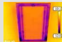
Традиционная лестница с утеплением 70 см - большие потери тепла по периметру.
